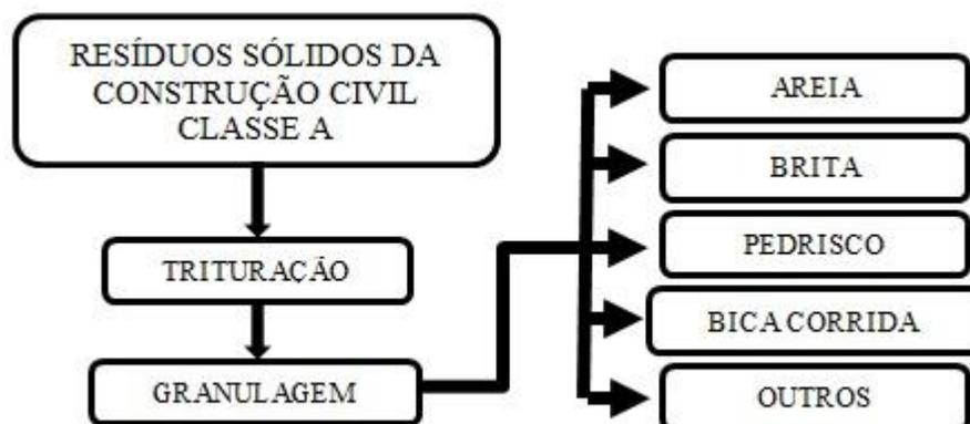
Figura 90 – Fluxograma de reciclagem dos RCC
